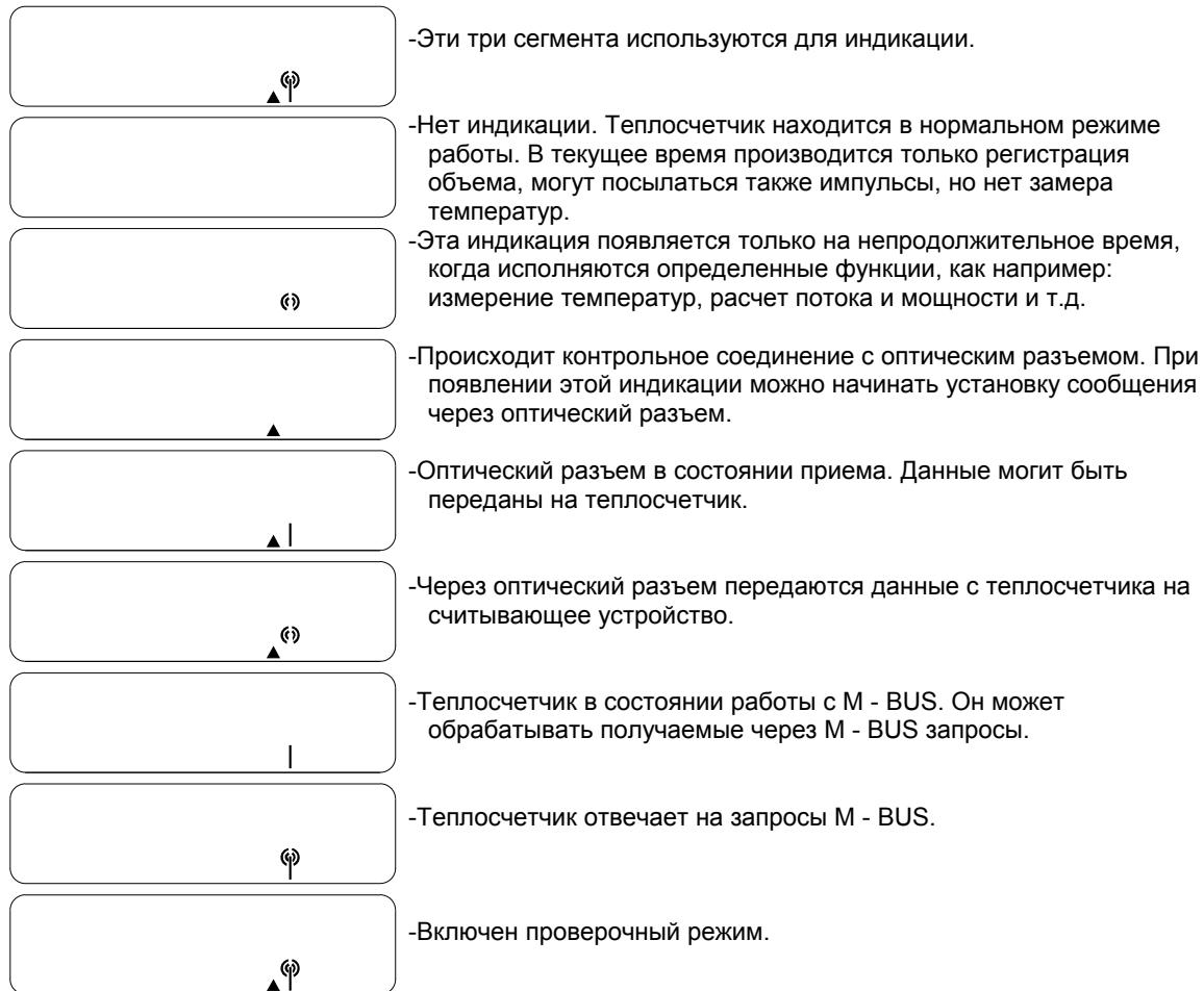
Кроме самой индикации состояния в любое время звездочкой показывается, когда принимаются импульсы. Если импульс распознается на одном из трех возможных импульсных входов, тогда звездочка индицируется в течение примерно 0.5 сек. При этом невозможно определить, когда появился импульс, как долго он продолжался или на каком входе он был принят.
